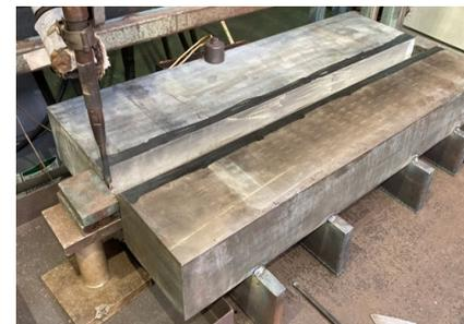
鍛造品の溶接施工試験
