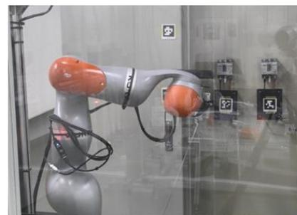
遠隔操作で盤内を点検する様子
