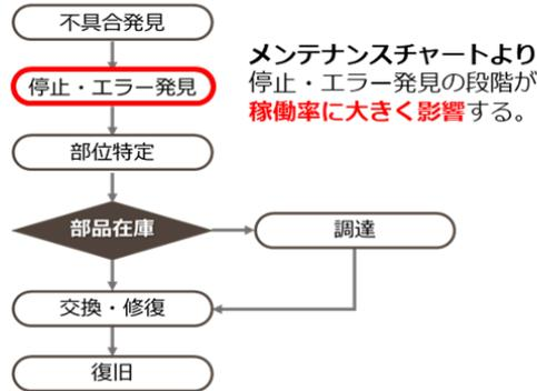
風車のメンテナンスにおいては、小さな故障の未発見・未処理が複合して大規模故障に繋がることから、早期に故障を発見しメンテナンス計画を立て修繕することが重要。特に洋上では、気象海象条件によってはアクセス制約があり、計画的かつ必要な処置を必要なタイミングで実施が求められる。
