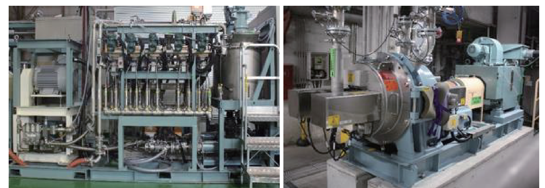
図1 新規解繊機(左:ノズル型 右:ディスク型)
