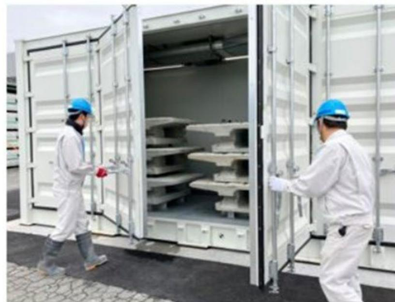
CO<sub>2</sub>-SUICOM炭酸化養生槽のイメージ
