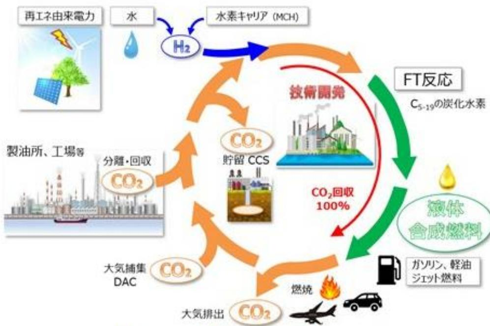
図1 CO<sub>2</sub>から液体合成燃料を製造するイメージ
