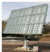
集光2軸追尾式(3kW)
