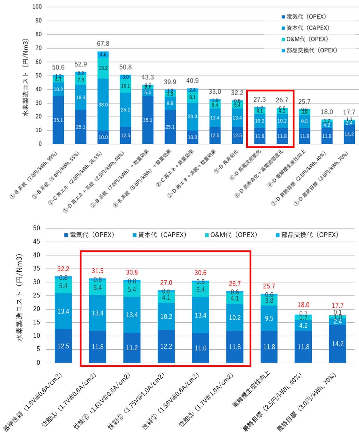
図 2.1.2-4 耐久性向上・高電流密度化による水素製造コスト低減
