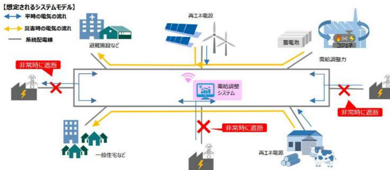
図 2-7-4 地域マイクログリッドのシステムモデル例
