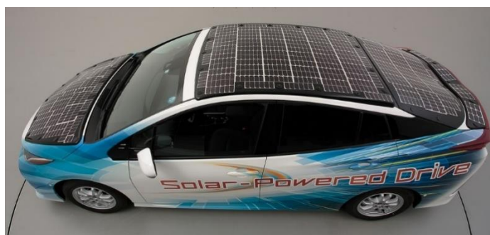
図 5-2-4-1 太陽光発電システムを搭載した公道走行用実証車
