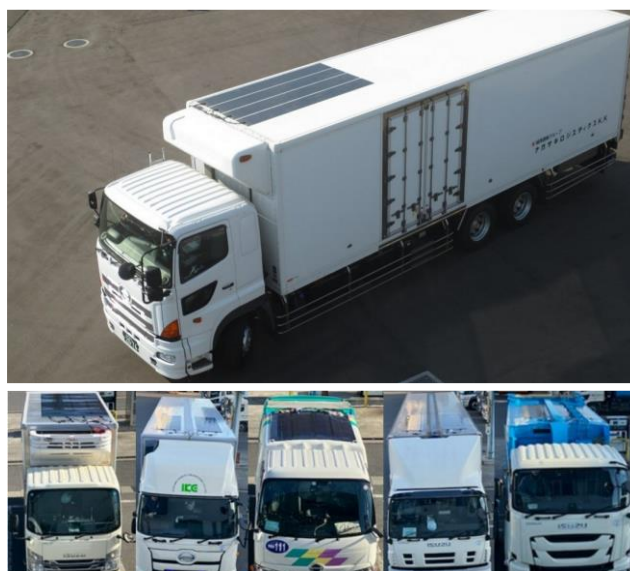
図 5-2-4-2 太陽光発電システムを搭載した公道走行用実証車
