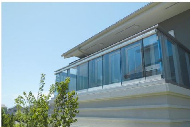
図5-2-3-3 ペロブスカイト太陽電池のベランダへの適用例 出典：Pnanasonic（株）HP より転載 https://news.panasonic.com/jp/press/in230831-1
