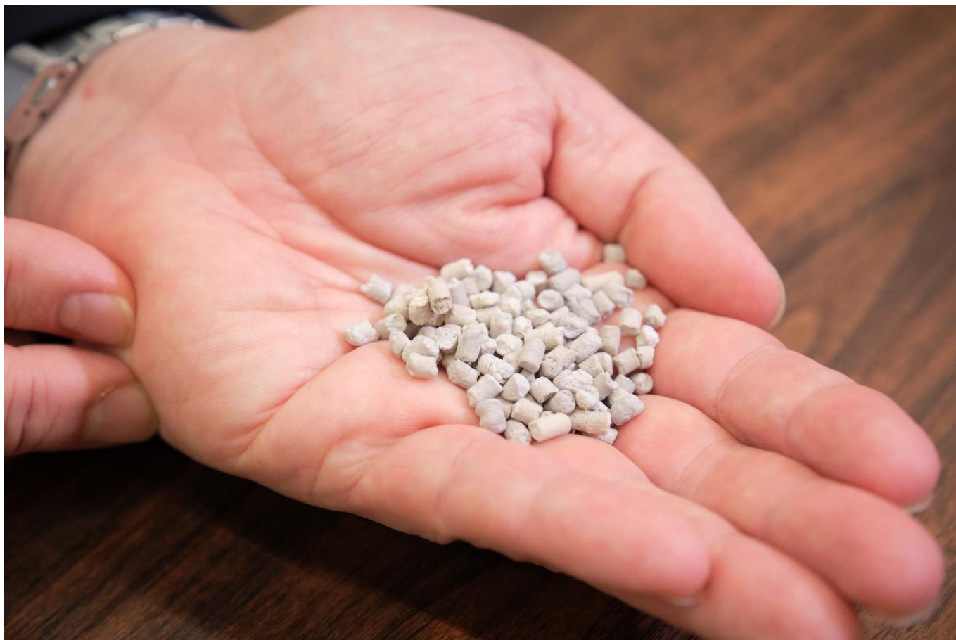
写真 2 無機系吸着材ハスクレイ
