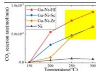
図②Ga-Ni-(Sc,Zr,Hf)系合金のメタネーション反応のCO2反応量
