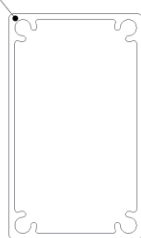
図 10-17 型材タッピンホール
