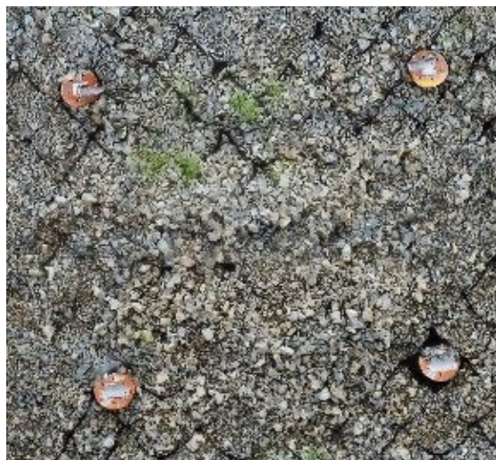
(b) Case 2 ジオセルに碎石を充填
