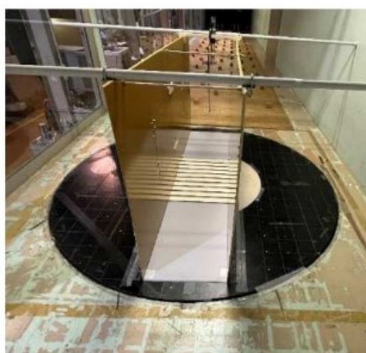
写真 2.1-1 風洞内模型設置状況（下流側から見る）
