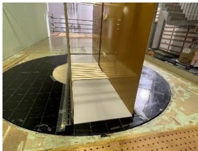
写真 3.3-1 太陽電池アレイ模型を用いて風圧測定をおこなった領域
