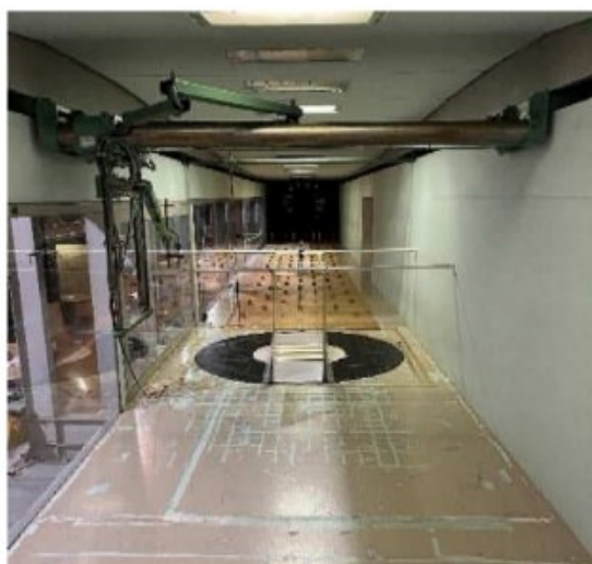
写真 2.1-1 風洞内模型設置状況（下流側から見る）
