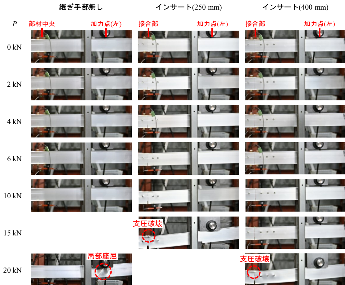
図 2-8 パネル受け材・パネル受け材継ぎ手部の損傷進展状況
