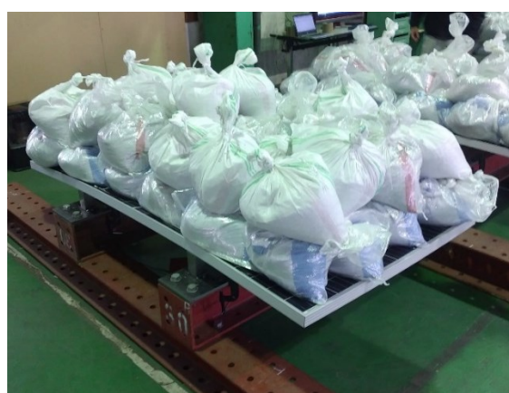
写真 5.2.4 砂袋載荷(3600 Pa)
