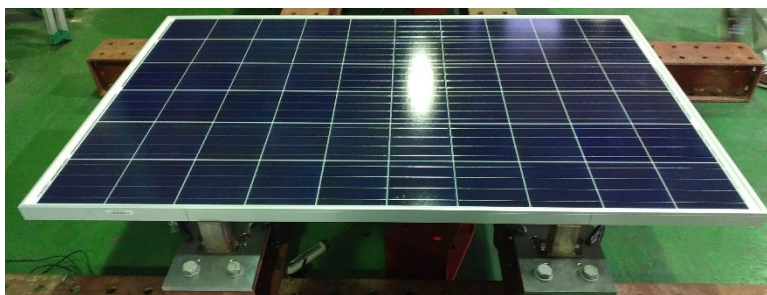
写真 5.2.1 60 セルモジュール(面積:1.6m 2 )
