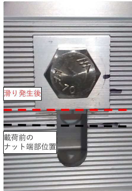
図 5.6.1 各接合部の荷重荷重と変位の関係 写真 5.6.4 補強なし接合部の変曲点におけるボルトの滑り
