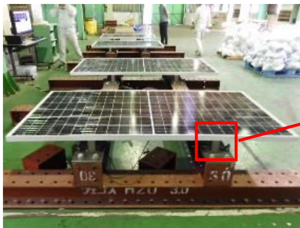
写真 5.2.5 ワイドモジュール除荷時の状況
