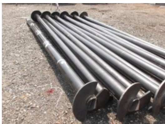
図 3.1.12 ⑨ アレイ支持物(先端加工杭)
