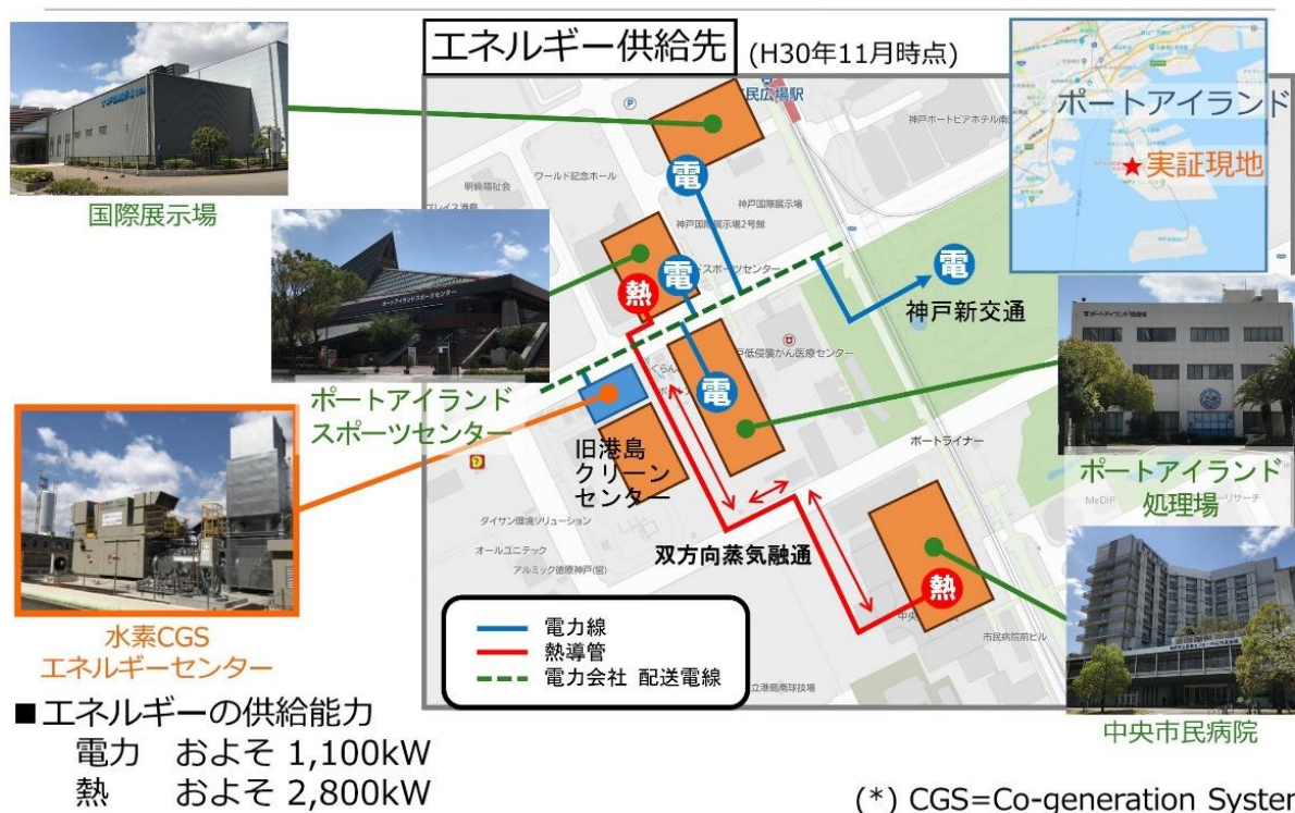
図 5 神戸における水素 CGS 実証の概略図 (提供 : 川崎重工業株式会社)
