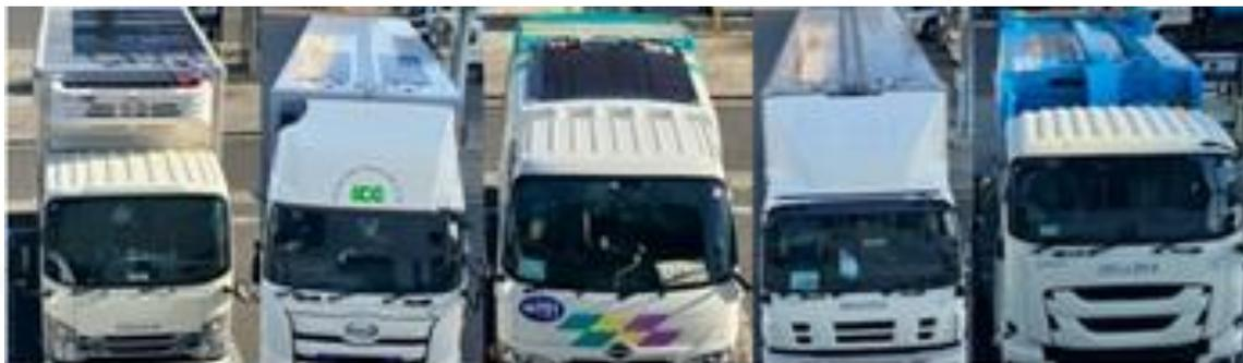
太陽光発電システムを搭載した行動走行用実証車
