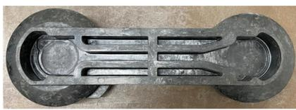
CFRP製ロボットアーム試作品(上図) およびプレス成形条件(右図)
