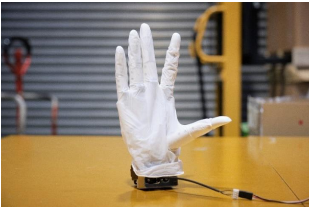
写真 11 完成した 5 本指の D-Hand のサンプル機。1 個の駆動源ですべての指が連動して動く。
