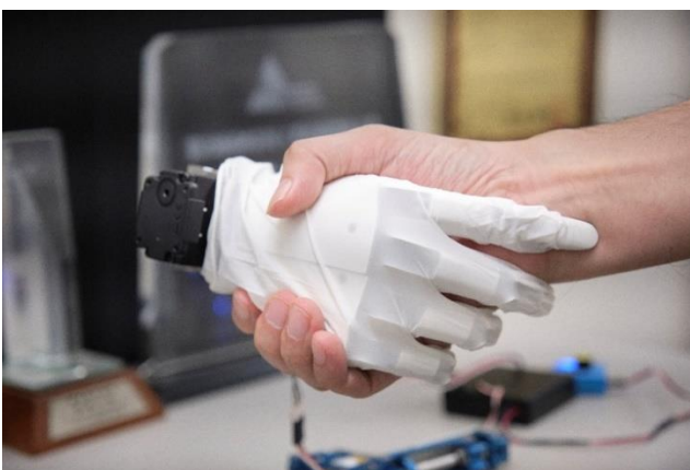
写真 11 完成した 5 本指の D-Hand のサンプル機。1 個の駆動源ですべての指が連動して動く。
