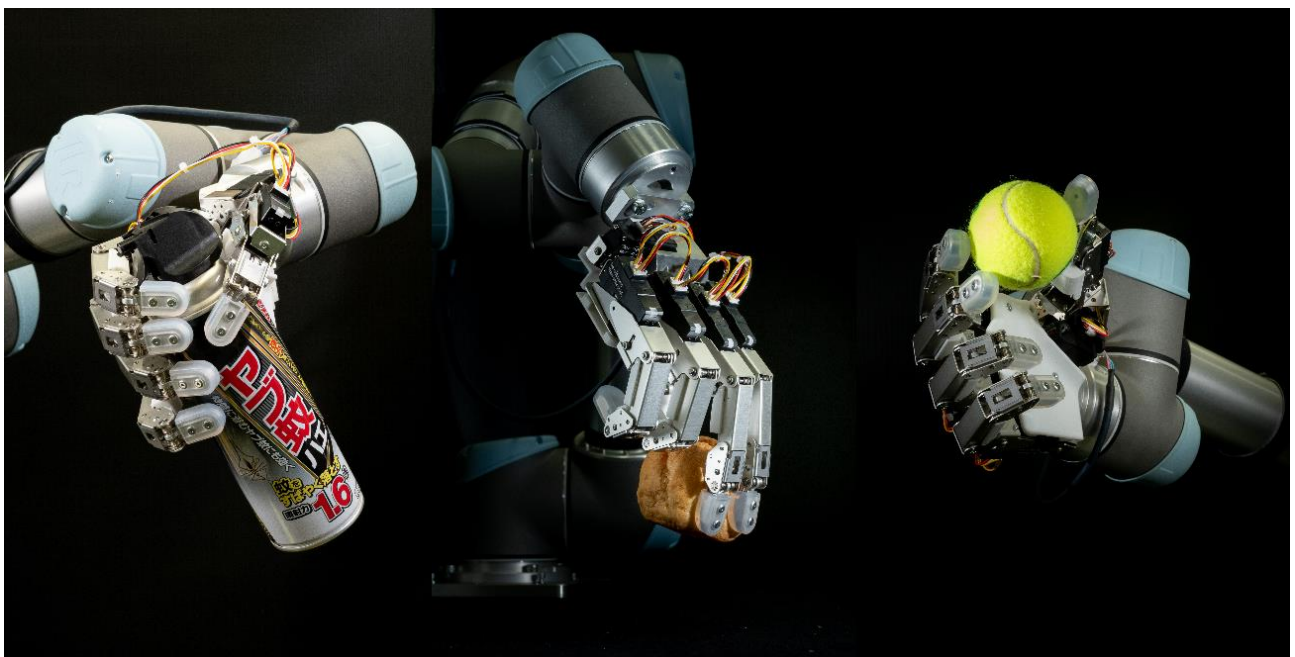
写真 16 それぞれの指が独立して駆動。4 本の指で缶を保持しながら、人差し指だけでスプレーの噴射のオンオフが可能なのもこのモデルならではの。シュークリームのような柔らかい物も、モーターの出力制御により、潰さずに持ち上げることができる。（提供：ダブル技研株式会社）
