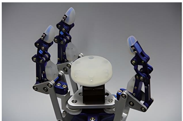
写真8 指の配列角度を変更し、円柱形の対象物を横から把持した際の D-Hand Type A。(提供：ダブル技研株式会社)
