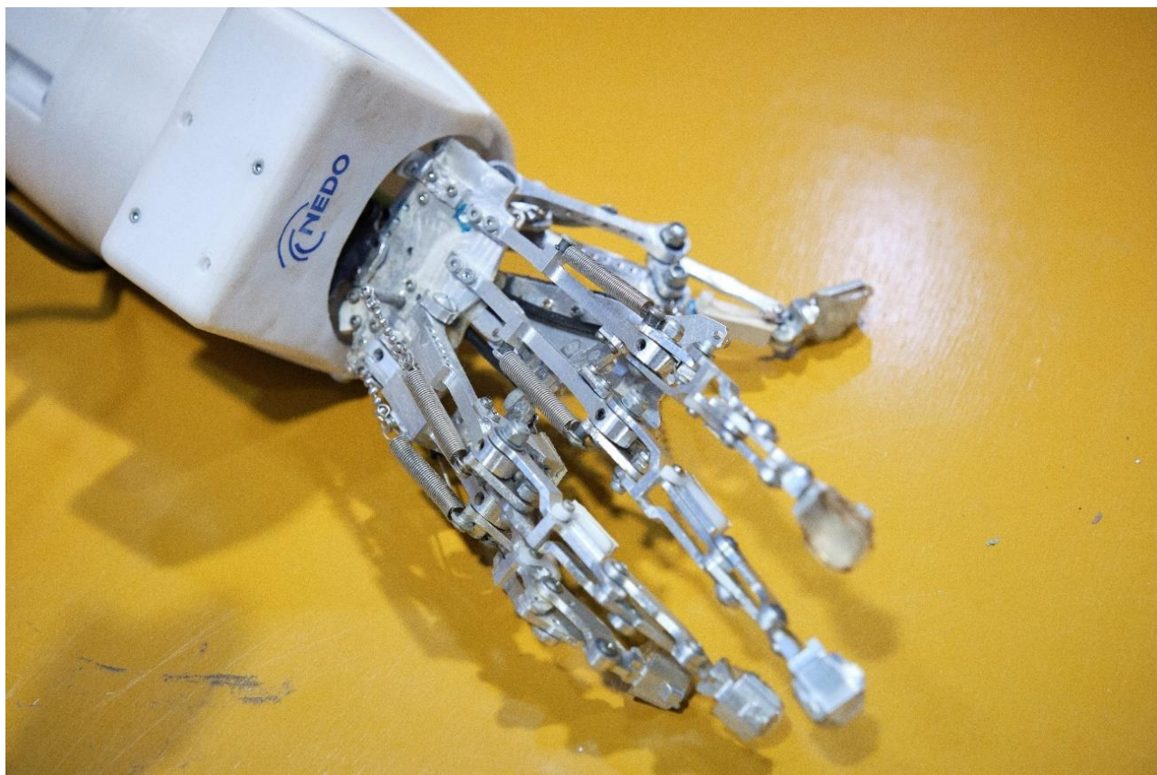
写真 10 開発初期の5本指モデルの D-Hand。
