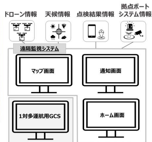
図 3. 遠隔監視システム
