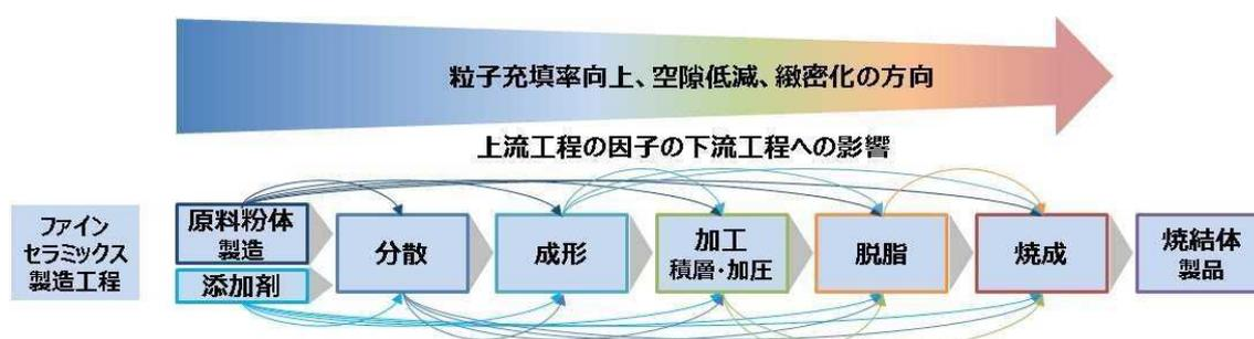
図 21 ファインセラミックス製造工程における工程間の因子の影響のイメージ出典：公開情報を基に NEDO 技術戦略研究センター作成 (2021)
