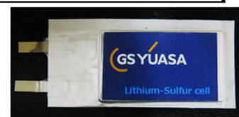
図 1. 実用仕様（5 Ah）の積層セル （質量エネルギー密度: 500 Wh/kg）
