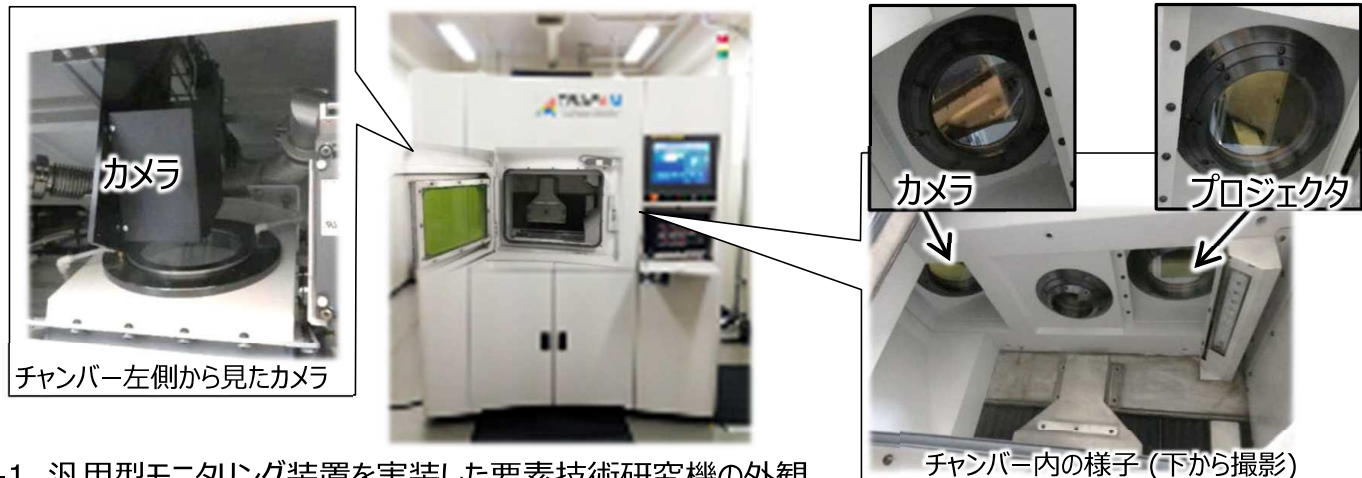
図2-1 汎用型モニタリング装置を実装した要素技術研究機の外観
