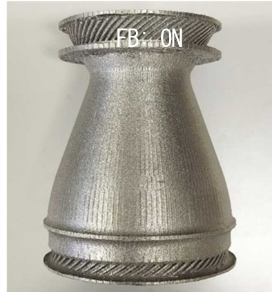
(a) 造形データの3Dモデル (b) フィードバック有 図 4-1-21 ユーザ造形の例 (A 社:IN718)
