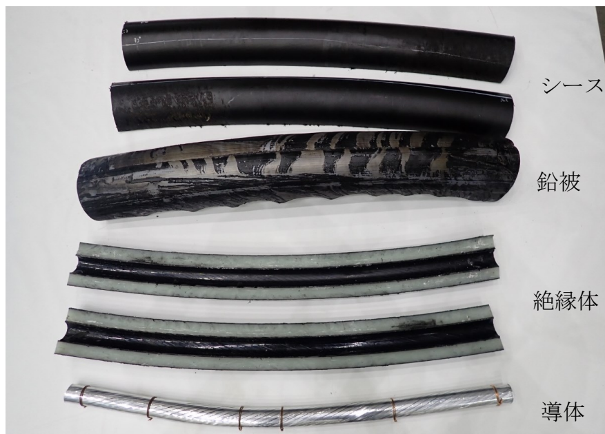
図 4-2-12 ケーブル解体調査
