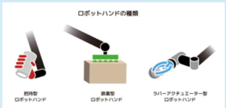
ロボットハンドには、把持型、吸着型、ラバーアクチュエーター型など様々なタイプが存在する。すでに成熟しているロボットアームに比べ、まだまだ伸びしろが多く進化が期待できる。
