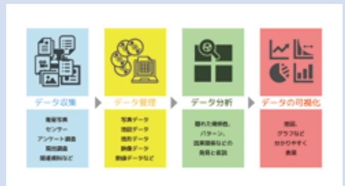
GIS解析の4ステップイメージ。データを集め、管理し、相互の関連性を分析したものを地図上にマッピングしたりグラフ化して可視化する。
