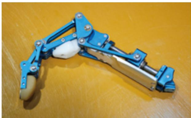
からくり機構は、人の手指の曲げ伸ばしに使われている腱の役割を、独自のリンク機構で再現。各所の動きに合わせて他の部位が連動して動く。
