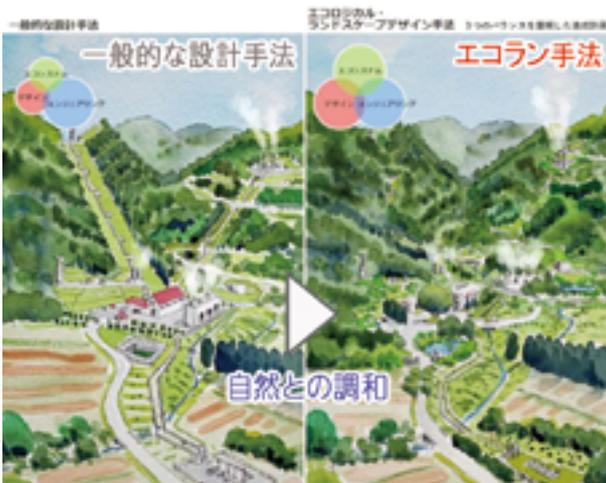
エコラン手法とは、一般的な設計手法と異なり、生態系、造成技術、景観の3つの要素が求める条件を同時に満たし、バランスのとれた空間づくりを目指す設計手法。エコラン手法の導入により、自然環境により調和した開発計画を策定することができる。（資料提供：東北緑化環境保全株式会社）
