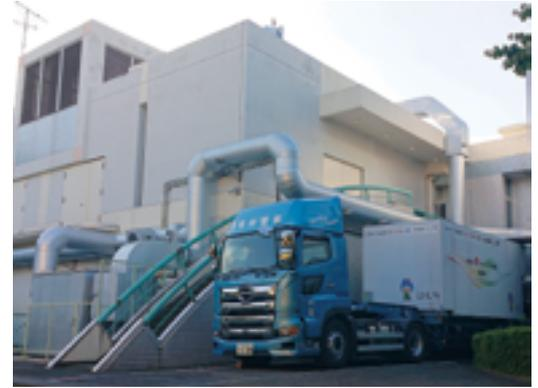
蓄熱槽の役割を蓄熱・放熱に逐次切り替えて運用するバッチ運転で、排熱場所と同じ施設内で熱利用する定置型実証の仕組図（左）。乾燥したハスクレイをトラック輸送して離れた場所で熱利用するオフライン熱輸送型の実証実験時の様子（右）。（資料提供：高砂熱学工業株式会社）
