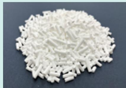
デシカント蓄熱技術を応用した吸着材ハスクレイ。水分の吸脱着の際に起こる蓄放熱のメカニズムを利用している。（資料提供：国立研究開発法人産業技術総合研究所）
