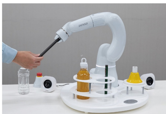
生成 AI ロボットの試作品がレーザーポインターを手渡す様子。「プレゼンに使う道具」などの抽象的な指示を解釈し、手元にある物品の中から適切なものを選ぶことができる
