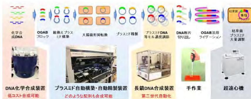
図2. 神戸大学に構築した長鎖DNA合成トータルシステム
