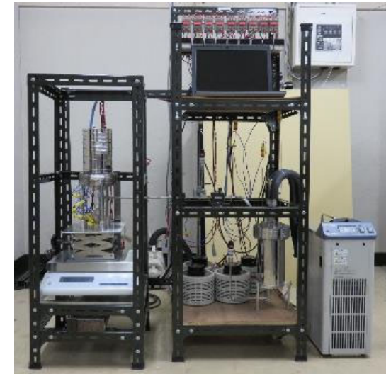
図1 小型充填層型化学蓄熱実験装置 [2]
