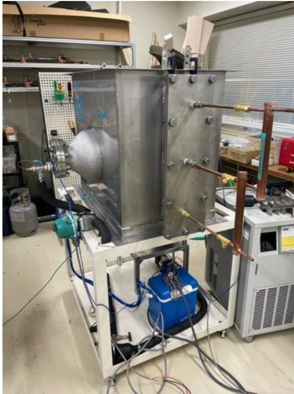
熱交換装置 2パス凝縮器用 (前方から)
