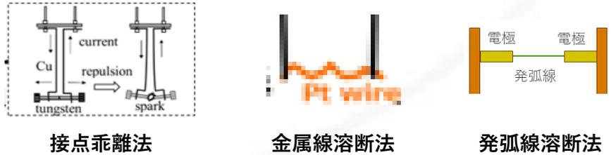
**中間年度成果：各種電極構造による発生エネルギーと自己分解伝播発生境界の比較検討を行い、国際標準化法に最適な電極構造を選定する**
