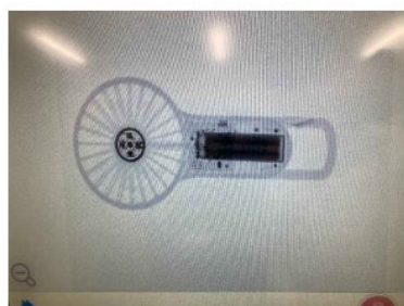
(a)X線画像により 電池の位置を特定
