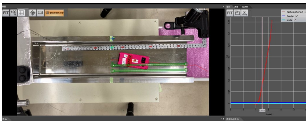
図 4-41 小型振動フィーダ実験の挙動解析
