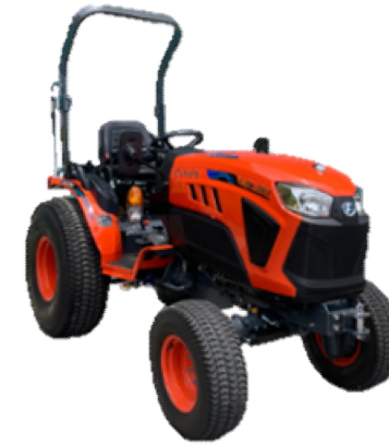
電動トラクタ (19.1kW)
