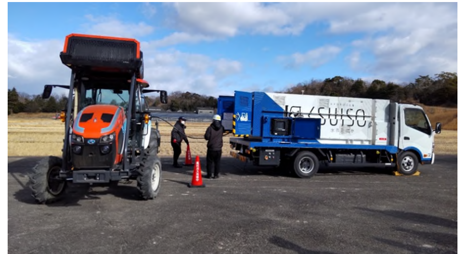
移動式充填車を用いた35MPa充填（愛知県農業総合試験場）
