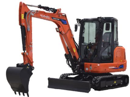
電動ミニバックホー (17.8kW)
