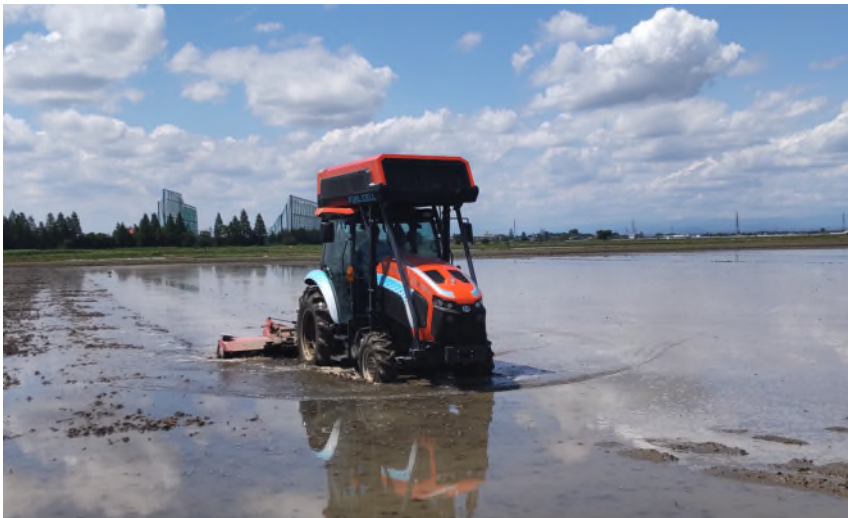
農研機構(埼玉県)での代掻き作業 (インプルメント：ドライブハロー)
