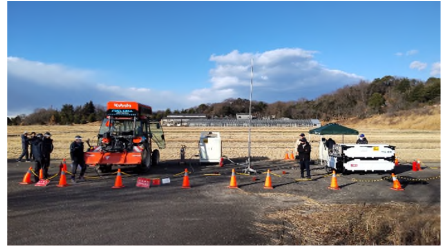
70MPa貯蔵モジュールを用いた簡易式充填（愛知県農業総合試験場）
