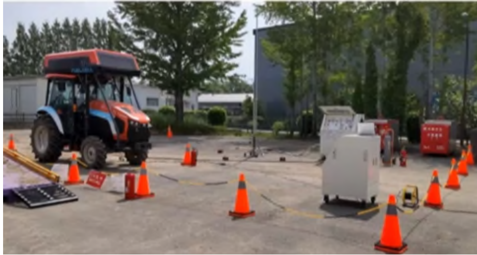
45MPaカードルを用いた簡易式充填（農研機構）
