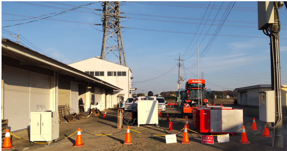
45MPaカードルを用いた簡易式充填（茨城県農業研究所）
