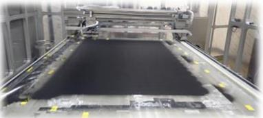
大面積CCM向けスプレー塗工装置
