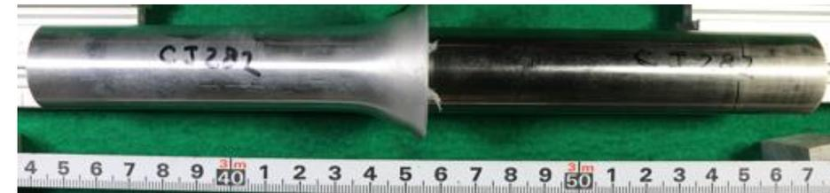
摩擦回転圧接継手
