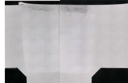
T継手FSW断面
