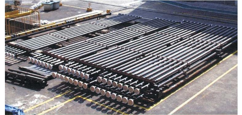
耐熱鋳鋼管（水蒸気改質管）
