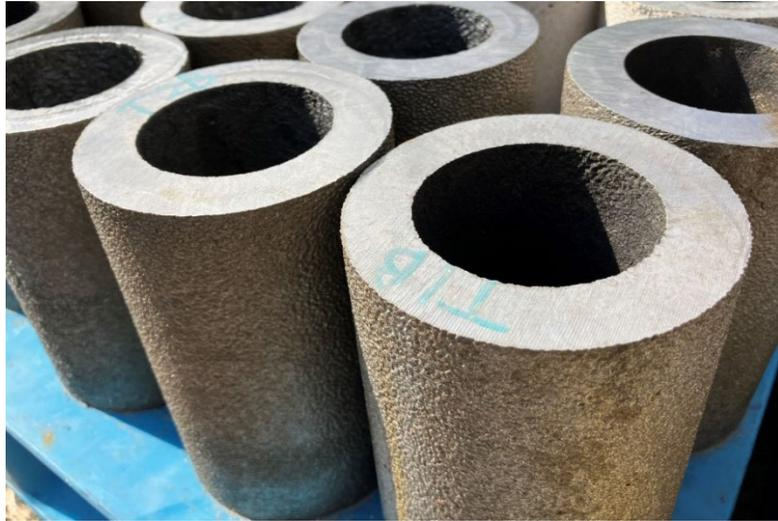
アンモニア分解プロセス特化材 試作鋳造サンプルの写真
