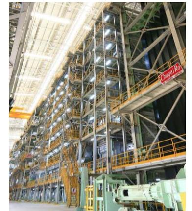
冷延鋼板連続焼鈍設備(CAL)
