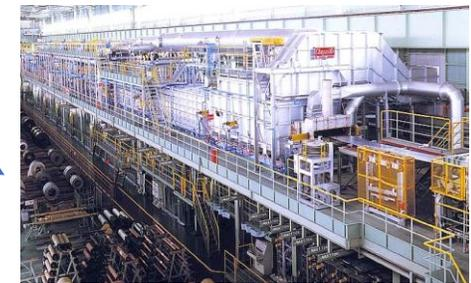
冷延鋼板連続焼鈍設備
