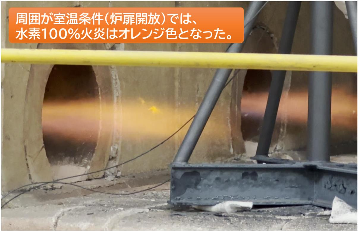
図: 室温条件(炉扉開放)での水素100%火炎の様子
