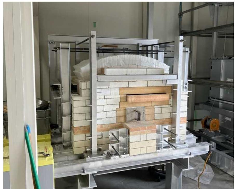
図8 酸素水素燃焼炉の外観
