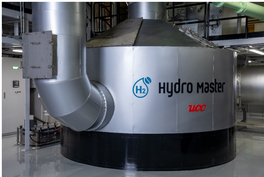
【工業用スケール水素焙煎機・脱臭機】 400kg/B 年間最大焙煎量6,000 t
