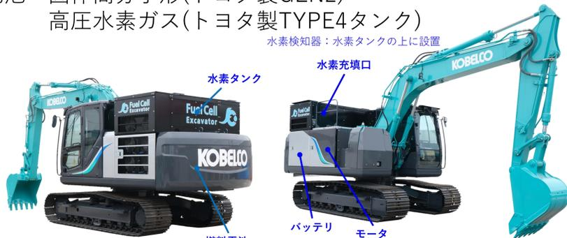
図4.燃料電池ショベル試験機
