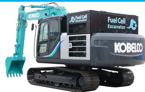
図1.燃料電池ショベル試験機
