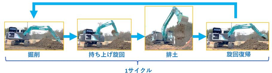
図3.標準的掘削作業
