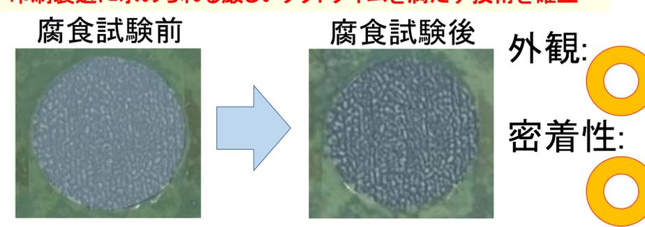
接触抵抗値: 10 mΩ cm<sup>2</sup> 接触抵抗値: 20 ~ 50 mΩ cm<sup>2</sup>
