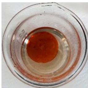
COF膜は高耐水性を有する (液水に対して変化なし)
