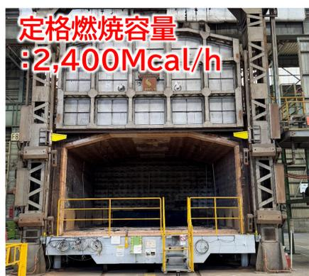
図:既設都市ガス加熱炉
