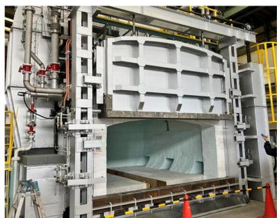
図:新設した評価用加熱炉
