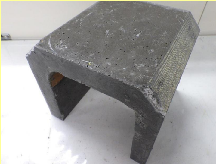
U字溝模擬供試体:長さ20cm程度
