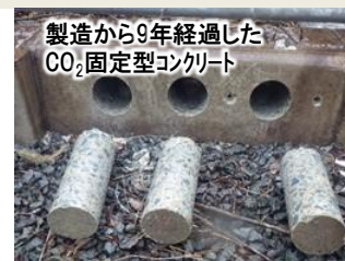
長期暴露とその後の破壊検査によるCO 2 固定量の測定例
