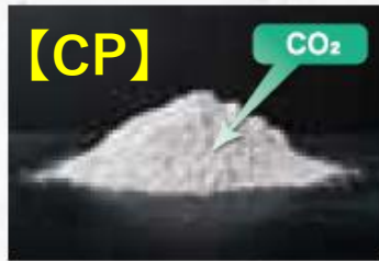
CO 2 固定再生微粉 (100kg-CO 2 /ton 微粉)
