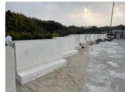
耐久性確認のための暴露実験
