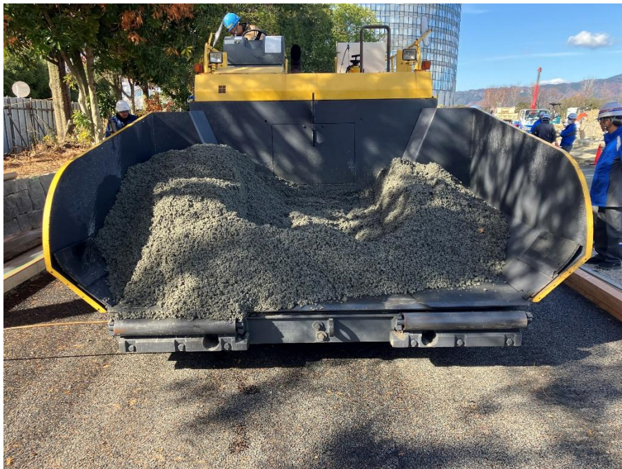
タンパ&バイブレータ仕様の アスファルトフィニッシャ
