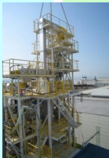
ベンチスケール試験設備 (~5t/day)
