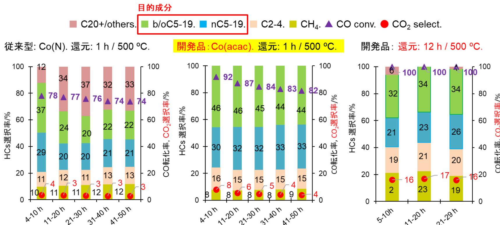
前処理: 500°C, 1 h. 反応圧力: 1.0 MPa (abs.), H<sub>2</sub>/CO: 2/1,
