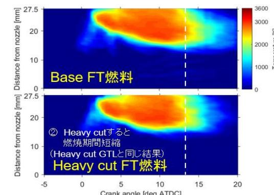
重質分 (Heavy) をカットすると、燃焼時間が短縮、冷却損失が低減し熱効率が改善する
